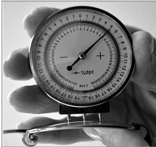
Рис. 2.34. Измерение базовой кривизны сферометром
