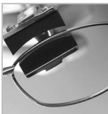
Рис. 2.7. Выправка ободка металлической оправы
