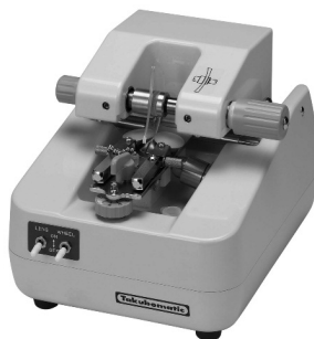
Рис. 2.74. Станок для нарезания паза под леску Takubomatic AG-5EX
