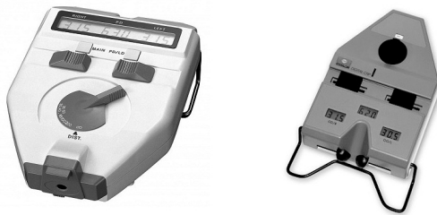
Рис. 2.25. Пупиллометры Shin Nippon PD-82 (Япония), Essilor DIGITAL CRP (Франция)
