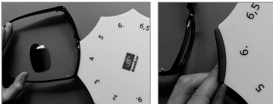
Рис. 2.35. Измерение кривизны оправы (базовая кривизна 4 D) и солнцезащитной линзы (базовая кривизна 6 D)
