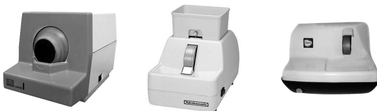
Рис. 2.65. Станки для доводки краёв очковых линз Essilor DIAFINE, Takubomatic NH-32, WECO 570
