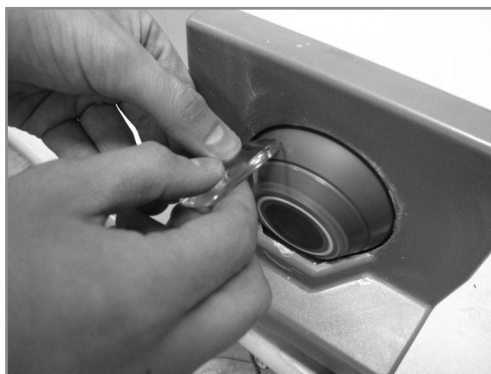
Рис. 2.66. Подшлифовка края очковой линзы на станке Essilor DIAFINE
