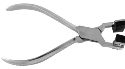
Рис. 2.7. Выправка ободка металлической оправы
