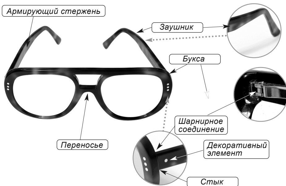
Рис. 1.4, б. Устройство пластиковых оправ
