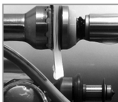
Рис. 2.99. Нанесение «спорт факета» специальным инструментом автоматической бесшаблонной системы Essilor Mr Orange
