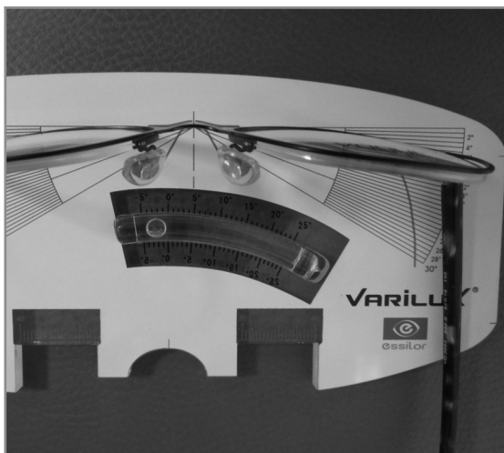
Рис. 2.22. Определение угла изгиба рамки оправы приспособлениями Essilor, Rodenstock, Zeiss
