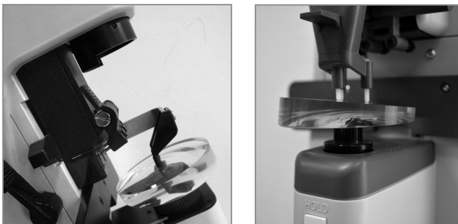
Рис. 2.55. Установка призматической линзы на окулярный и автоматический диоптриметры при разметке по рецепту Sph -6,00 Pr 6,0 bas 45^\circ
