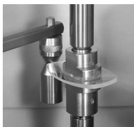
Рис. 2.94. Сканирование толщины и геометрии линзы на станках Takubomatic E-1000 (слева) и Essilor (справа)
