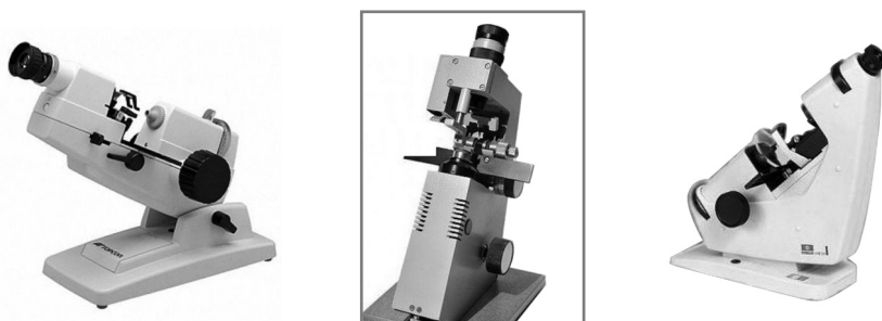
Рис. 2.40. Диоптриметр LM-8 TOPCON (Япония) с компенсатором призмы, диоптриметры ДО-3 (Россия) и LME 60 ESSILOR (Франция)
