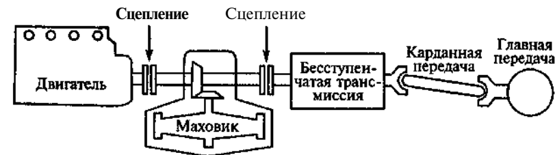
Рис. 42.3. Конструктивная схема трансмиссии с маховичным накопителем энергии
