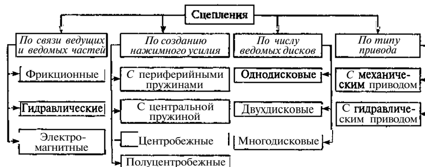
Рис. 31.1. Типы сцеплений
