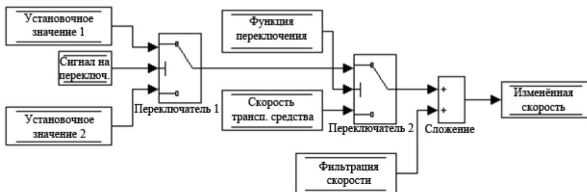
Рис. 2.10. Расчет рассогласования скорости и уставки
