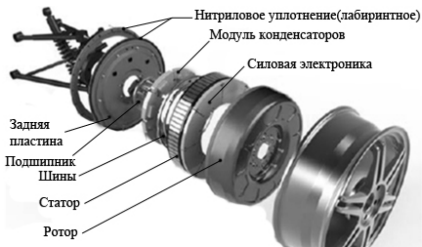
Рис. 1.17. Конструкция мотор-колесо фирмы Protean
