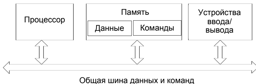
Рис. 1.11. Архитектура с общей шиной данных и команд
