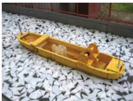
Испытания нефтегазодобывающей платформы в ледовых условиях / Oil and gas production platform test in ice conditions
