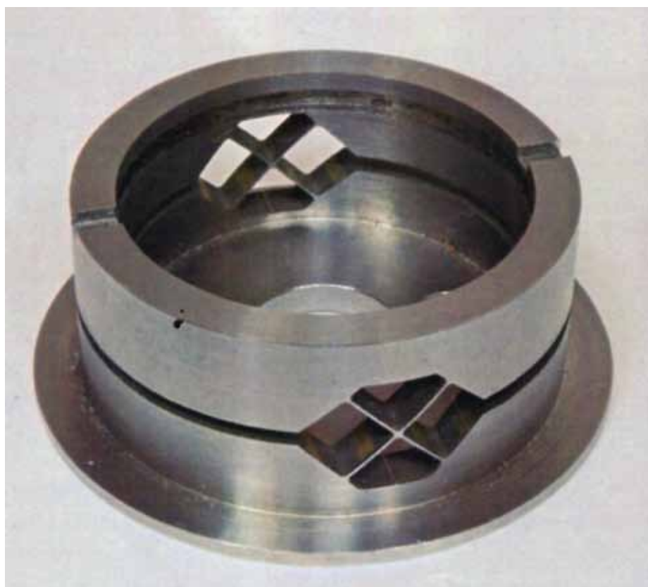
Макет конструкции цельного гироскопа (корпуса и крестообразных перемычек), выполненные из цельной заготовки
