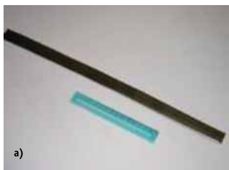
Внешний вид элемента ТУМ, плакированного никелем, из порошка Нибон-20 а) внешний вид ленты б) торцевой срез уплотнительной планкированной ленты
