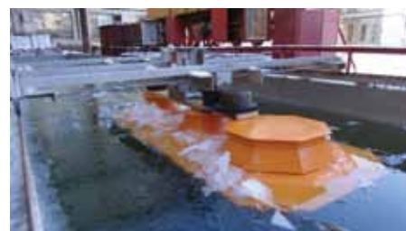
Испытания нефтегазодобывающей платформы в ледовых условиях / Oil and gas production platform test in ice conditions
