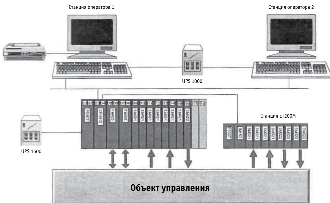
Структурная схема автоматизации процесса получения водорода / Scheme of Automatable process of Hydrogen formation
