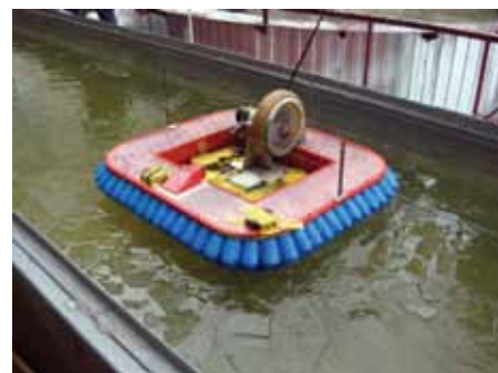
Испытания модели ЛПВП и ледоколов в бассейне НГТУ / Ground-effect research ice machine and icebreakers test in the ice model basin of NNSTU
