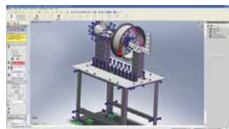
Моделирование болтовых и винтовых соединений новой разборной конструкции стенда при расчете напряженно-деформируемого состояния стенда в программе «SolidWorks 2007» / Bolting and screwing model test of a new clastic stand in arriving at stand strain-stress state in «SolidWorks 2007»
