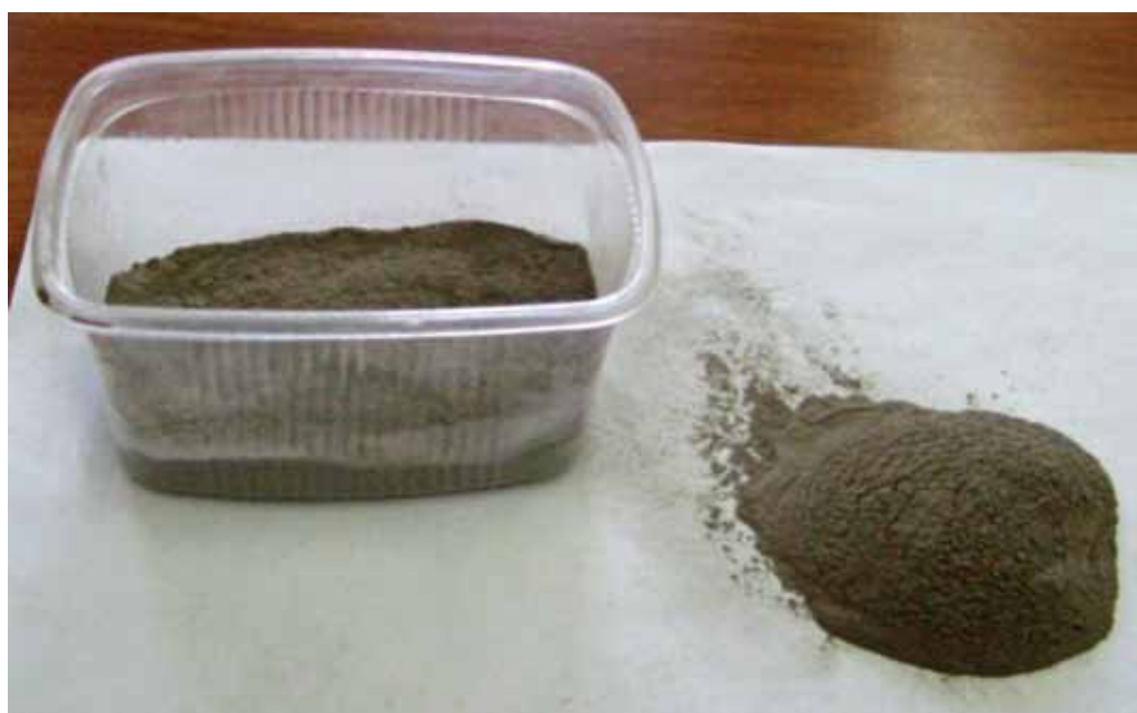
Алюмошлаковый наполнитель противопригарных покрытий Aluminum slug filter for anti-stick coatings
