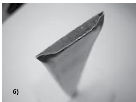
Внешний вид элемента ТУМ, плакированного никелем, из порошка Нибон-20 а) внешний вид ленты б) торцевой срез уплотнительной планкированной ленты
